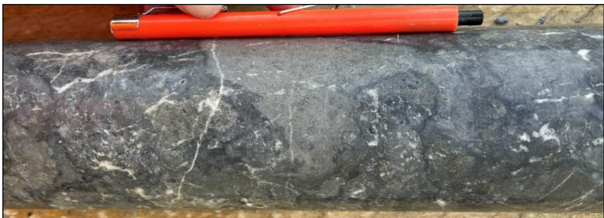
Ragged Dacite clast in Andesite-dacite breccia. 378.4m.
